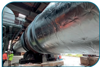
L'optimisation de la dégradation matière dans le BRS (bioréacteur) par le calorifugeage et la ventilation embarquée et contrôlée a permis d'améliorer la qualité de la matière organique.
